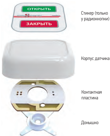
Составные части радиодатчика
