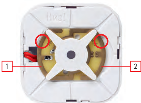
Замыкание контактов 1 и 2 для прописки датчиков
