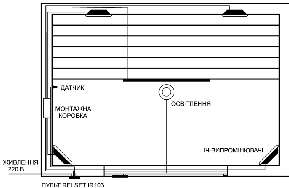
Мал. 1. Рекомендована схема розміщення обладнання.
