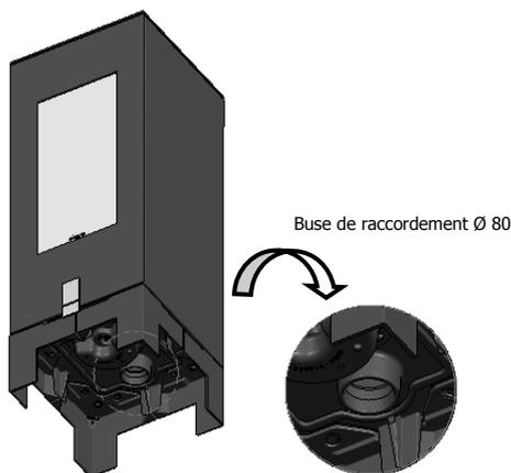
Ce poêle a été conçu pour être installé dans les maisons types BBC. Il est entièrement étanche et grâce à un raccordement (buse Ø 80), il permet de prendre l'air de combustion directement à l'extérieur sans le prélever dans la pièce. Il est compatible avec les solutions de ventilation de type VMC double flux et hygro-réglable.
