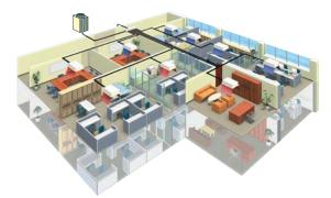
В современной серии наружных блоков G4 заложена модульность, то есть существуют несколько модулей наружных блоков, из которых формируются все мощностные модификации наружных агрегатов. В серии G4 применяются только компрессоры с инверторным приводом. Это продлевает срок службы систем и уменьшает нагрузку на электрическую сеть, так как полностью отсутствуют высокие пусковые токи.
