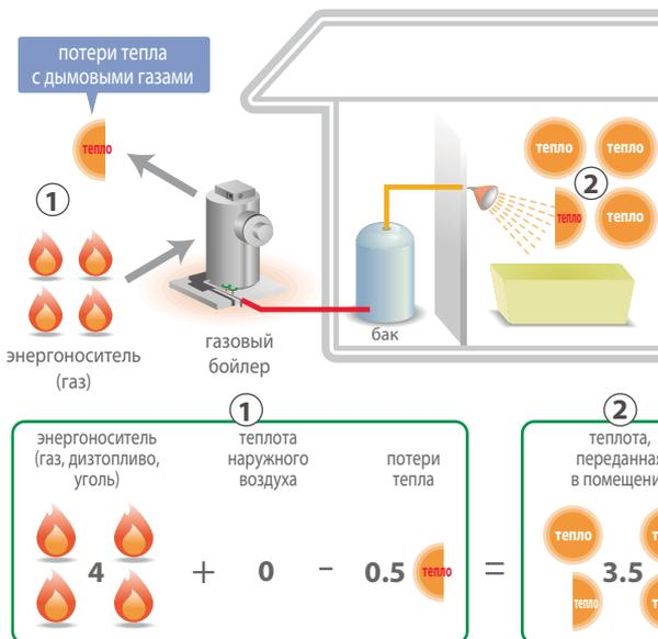
Принцип получения тепла с помощью теплового насоса отличается от традиционных систем нагрева, основанных на сжигании газа или жидкого топлива, а также прямого преобразования электрической энергии в тепловую. В таких системах единица энергии энергоносителя преобразуется в неполную единицу тепловой энергии. В то время как тепловой насос, затрачивая единицу
