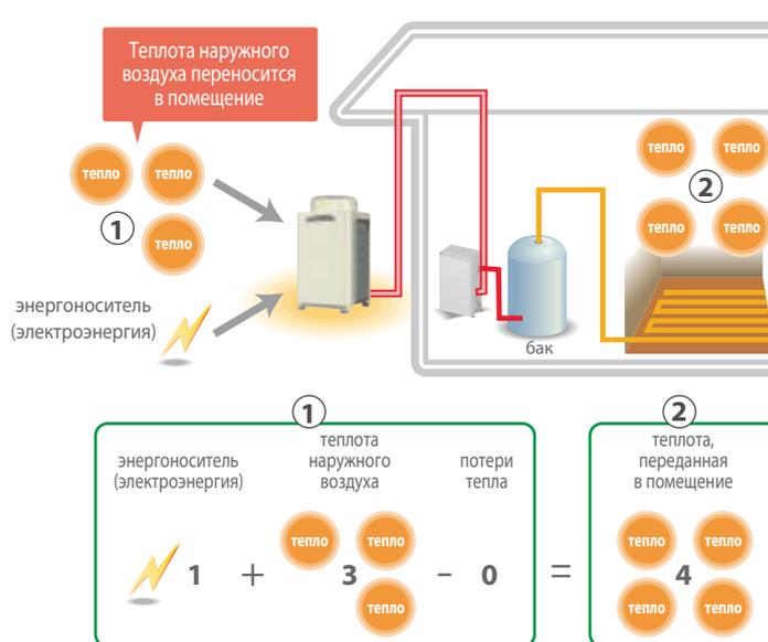
электрической энергии, «перекачивает» в помещение от 2 до 6 единиц тепловой энергии, забирая ее из наружного воздуха. Поэтому высокая эффективность воздушного теплового насоса делает естественным выбор в пользу таких систем для отопления помещений и нагрева воды на объектах, имеющих ограниченные энергоресурсы.
