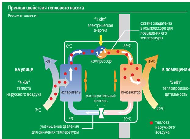
Далее этот поток поступает в теплообменник (испаритель), связанный с окружающей средой (например, воздушный теплообменник на улице). При низком давлении жидкость испаряется (превращается в газ) при температуре ниже, чем температура наружного воздуха или грунта. В результате часть тепла наружного
