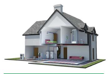
Бивалентные системы имеют в своем составе 2 источника тепла для расширения температурного диапазона, снижения капитальных затрат и увеличения надежности.
