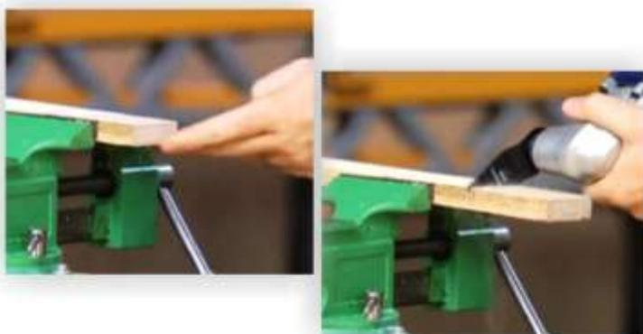
Используя Renovator спил получается очень гладким, без грубых краев, которые образуются при работе с ручной циркулярной пилой или ножовкой, а это не допустимо при работе с дорогостоящим материалом или изделием. Все из-за эффекта шлифовки!
