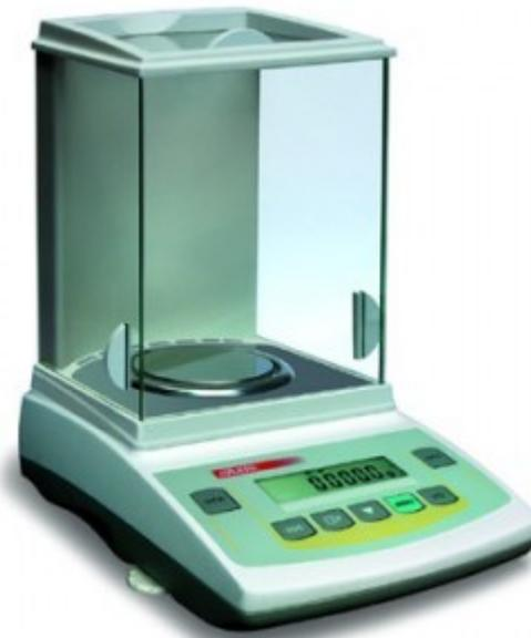
Профессиональные весы аналитические электронные AXIS серии ANG...C с автоматической внутренней калибровкой, легко адаптируются к изменениям окружающей среды и отличаются исключительной точностью измерений, стабильностью показов и надежностью, которые сочетаются с современным дизайном, прочностью конструкции (алюминиевый сплав), удобством (стеклянная витрина с трехсторонним доступом) и простотой в использовании.
