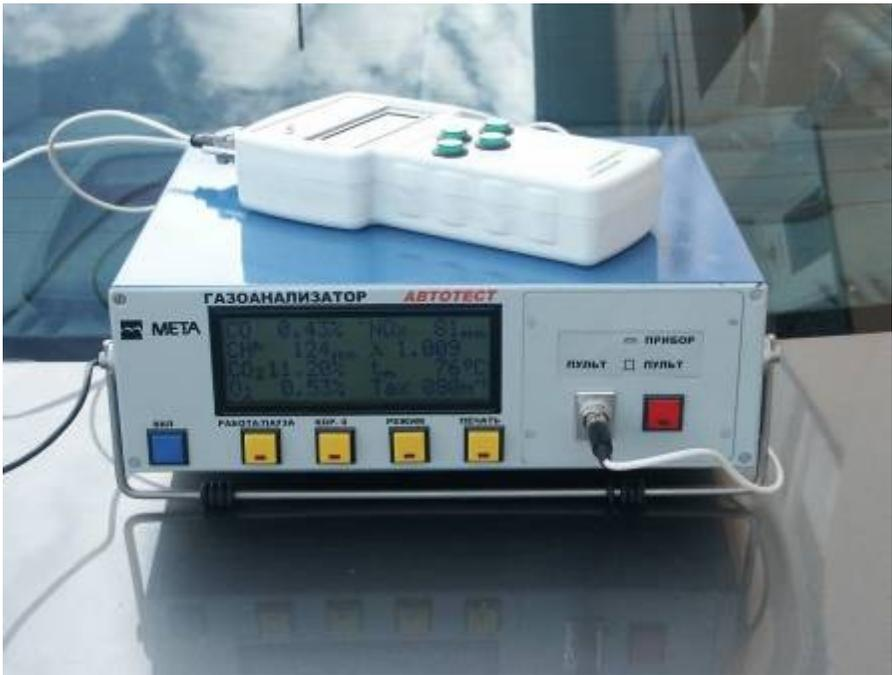
Рисунок 1в - Внешний вид газоанализатора с подключенным пультом дистанционного управления
