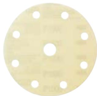
Микротонкие абразивные круги для сухой шлифовки с помощью шлифовальной машинки. Разработаны для удаления мелких дефектов лакокрасочного покрытия. Абразив рекомендовано применять на орбитально-эксцентриковых машинах с малым ходом эксцентрика, на мягких оправках и использовать с мягкими подложками, что обеспечит хорошее прилегание абразива к сложным контурам поверхности автомобиля.
