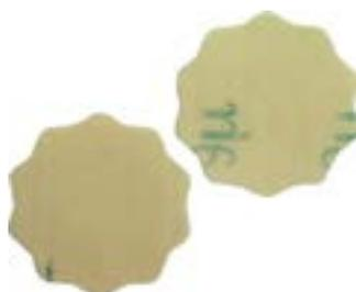
Абразивные цветки зернистостью 9 мкм применяются для устранения мелких дефектов (например, частиц пыли) на новых и перекрашенных лакокрасочных покрытиях. Абразивные цветки имеют самоклеящуюся пленочную основу для работы с красными бочонками Finesse-it™ (номер по каталогу – 50199). Форма цветка предотвращает появление риска при обработке контуров.
