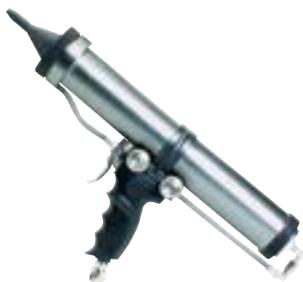
Пневматический универсальный пистолет может быть использован для нанесения как выдавливаемых, так и распыляемых герметиков. Регулируя подачу материала (ход поршня – синий регулятор) и подачу воздуха (красный регулятор) мастер может получить любую структуру наносимого герметика.
