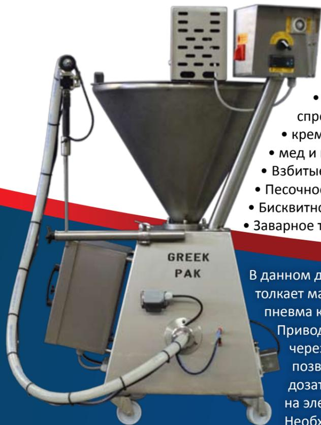
В данном дозаторе под бункером установлен шнек который толкает массу по шлангам к пистолету. На пистолете установлен пневма клапан открывания и закрывания дозирующего сопла.
