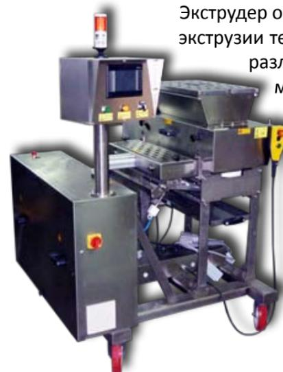
Экструдер оборудован двигателем с помощью которого вращаются два вала для экструзии теста. В зависимости от формы-шаблона, тесто выходит в виде палочек различных диаметров и форм по спецификации заказчика. Имеется возможность установки системы горизонтальной резки.
