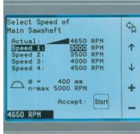
Привод VARIO: бесступенчатое варьирование скорости вращения
