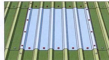
Металлический погодостойкий лист закрепляется на прилегающем ряду. Боковая сторона металлического листа закрепляется под стороной осветительного окна, на пластил о накладывается изоляционная лента, соединения герметизируются и боковые соединения сшиваются. Вокруг осветительного окна используются легко заметные фиксирующие головки.
