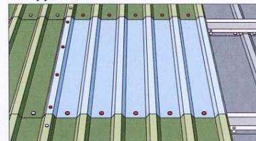
Металлическая прокладка и Z-образные секции крепятся на прилегающий ряд с у же закреплённым боковым соединением внахлест металлического листа под покрытие из материала Marlon CS Longlife. Соединения герметизируются, боковые соединения сшиваются.
