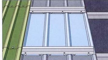
Металлическая облицовка над осветительными окнами накладывается внахлест, герметизируется, закрепляется и сшивается. Z-образные секции, установленные на флюсовых шайбах, крепятся к обрешетине сквозь облицовку.
