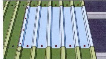
Склон металлической погодостойкой прокладки укладывается до погодостойкого листа из материала Marlon CS Longlife. Изоляционная лента накладывается на пластизоловое покрытие там, где лист из материала Marlon CS Longlife внахлест накладывается на торец и стороны прилегающих листов. Погодостойкий лист из материала Marlon CS Longlife закрепляется, затем на склон накладывается металлический лист. Соединения герметизируются и боковые соединения сшиваются.
