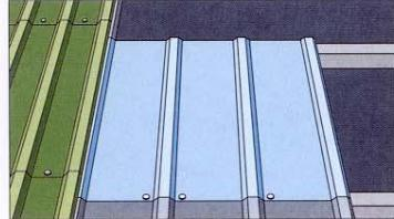
Торец облицовочной панели из материала Marlon CS Longlife накладывается внахлест на расположенную под ним металлическую облицовку – герметизируется и прикрепляется к обрешетине. Стороны накладываются на прилегающие ряды металлической облицовки. Соединение герметизируется и сшивается.
