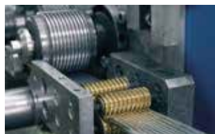
Цех изготовления гибких воздуховодов
