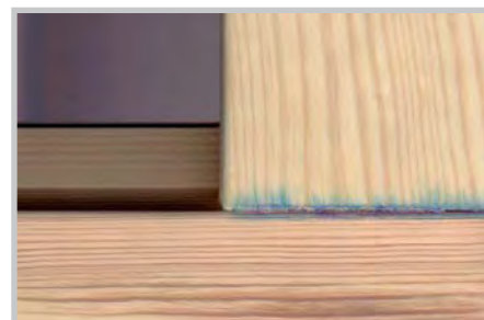
Водоотталкивающее действие Induline SW-900 – эффективная блокировка.
