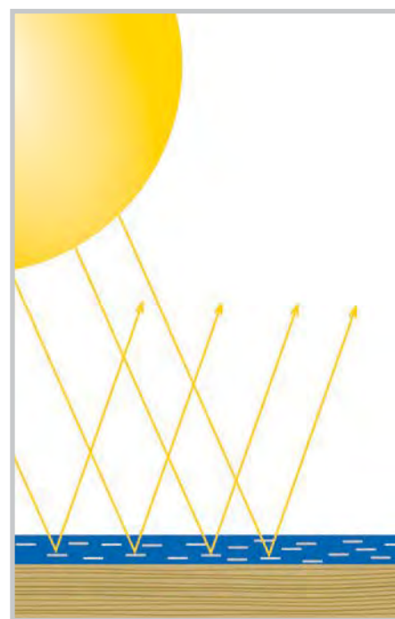
Оптимальное расположение крупных частиц алюминия в Induline ZW-420 обеспечивает равномерное отражение – ярко выраженный металлический эффект.
