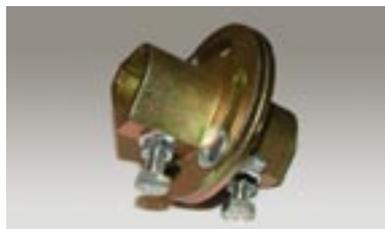
Составные валы секционных ворот соединяются при помощи специальной муфты, позволяющей при монтаже ворот проворачивать две части относительно друг друга, обеспечивая тем самым равномерное и одинаковое натяжение тяговых тросов. Благодаря этому удается избежать перекосов секционных ворот во время эксплуатации.
