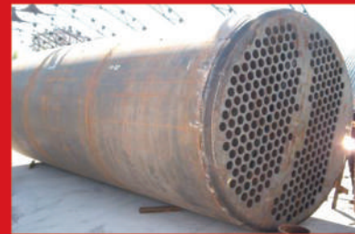
Производство паровых твердотопливных котлов гибридного типа с жаротрубной передней топкой
