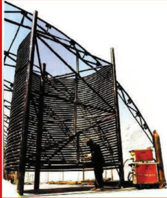
Производство паровых твердотопливных котлов гибридного типа с жаротрубной передней топкой
