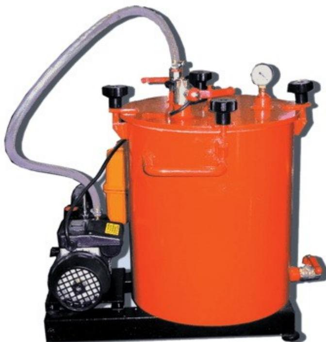
Установка вакуумная УВ-Ф предназначена для определения водонасыщения образцов из асфальтобетона, приготовленных в лабораторных условиях или образцов, отобранных из покрытия или основания дороги в виде кернов или вырубок по ГОСТ 12801-98.
