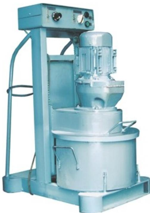
Мешалка лабораторная МЛА-30 предназначена для приготовления асфальтобетонов (песчаного, мелкозернистого, среднезернистого) в дорожных лабораториях.
