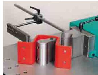
62 Manueller 2-Achsen Anschlag Manual 2-axis back gauge M600
