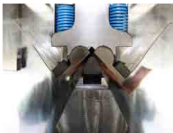
65 Abdruckfreies Biegen Bending without marks
