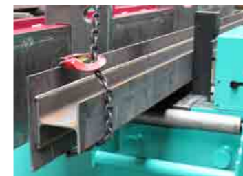
119 Geschweisste Träger richten Welded beam straightening
