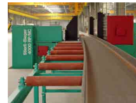
274 Mit oder ohne angetriebene Rollenbahn With or without driven roller conveyor
