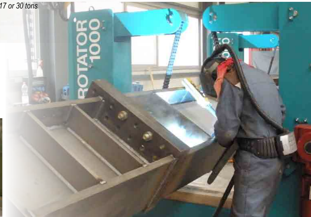
312 Schweißen und Verputzen in Wannennlage erhöht die Produktivität Welding and dressing in sag curve increases productivity
