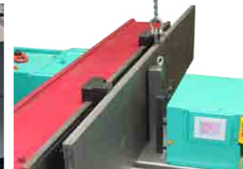
112 Richten nach dem Brennschneiden Straightening after thermal cutting
