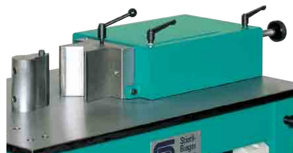
182 Hub-Feineinstellung für präzises Biegen bei 85 HE/ 120 HE Stroke adjustment for precise bending at 85 HE and 120 HE
