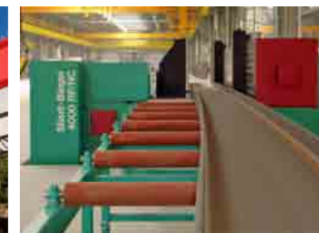
122 Träger vorspannen / überhöhen Beam cambering / bending
