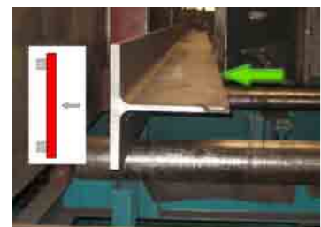
104 Richten nach dem Brennschneiden Straightening after thermal cutting
