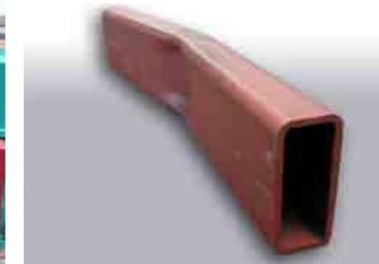
114 Knicken von Rohren und Träger Kink of tubes and beams
