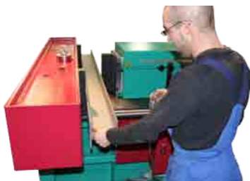
105 Richten mit Richtkabel Straightening with hand cable
