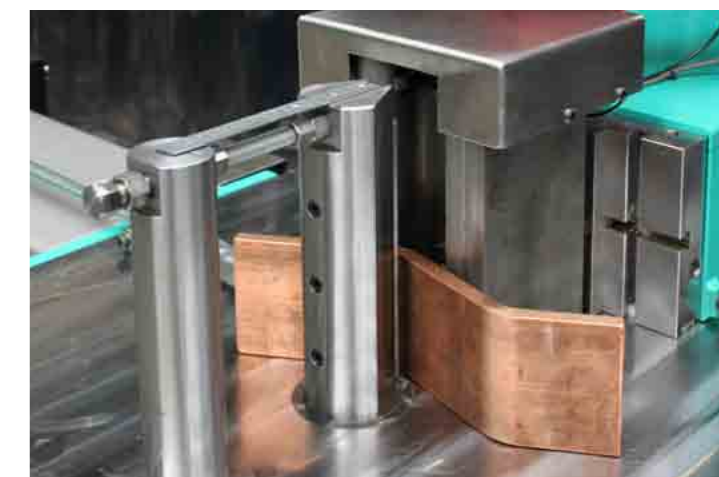
211 Schmäler Biegestempel mit auswechselbaren gehärteten Radius-Einsätzen Narrow section punch with changeable Radius inserts
