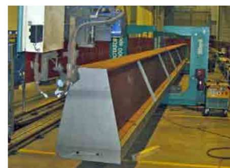
313 Einstellbare Arbeitshöhe + 2 Drehrichtungen Adjustable height and 2 turning directions
