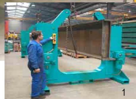
301 Träger absenken Lower the beam
