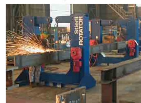
312 Schweißen und Verputzen in Wannennlage erhöht die Produktivität Welding and dressing in sag curve increases productivity
