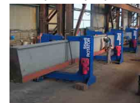
314 Mehrere Rotatoren für sehr lange Teile Several Rotators for very long parts
