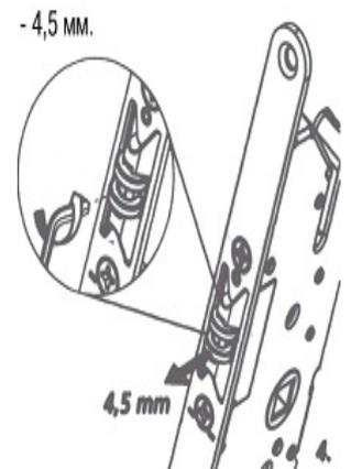
Диапазон регулировки роликовой защелки - 4,5 мм.
