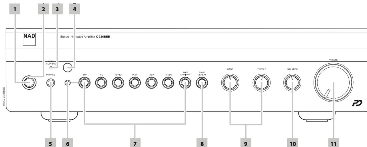
**1 КНОПКА STANDBY:** Если кнопка POWER (Питание) на задней панели находится в положении ON (Вкл.), нажмите эту кнопку, чтобы включить Интегрированный стереоусилитель C 326BEE из режима ожидания. Светодиодный индикатор режима ожидания изменит цвет с желтого на синий. Повторное нажатие кнопки STANDBY возвращает устройство в режим ожидания.
