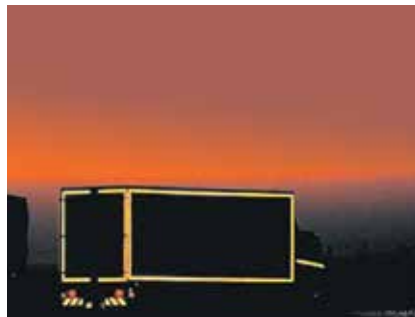
Рис. 86. Для маркировки транспорта применяется пленка алмазного класса с улучшенными световозвращающими характеристиками (серия 983).
