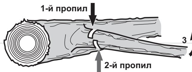
Процес обрізки сучків і гілок з поваленого дерева дуже нагадує процес розкряжування.
