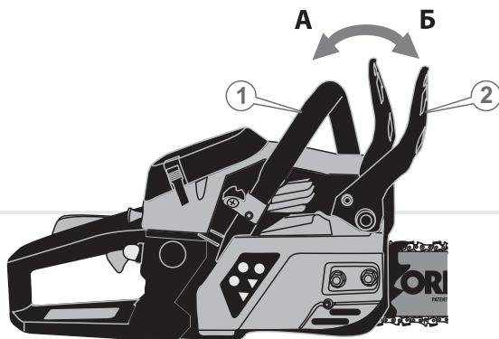
Тормоз цепи расторможен (разблокирован – цепь может вращаться), когда его рычаг находится во взвешенном положении (А) – рычаг (2) потянут в сторону передней рукоятки (1) (см. рисунок 9).
