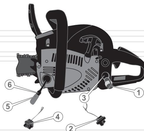
**Обслуживание топливного фильтра**
