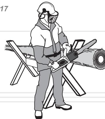
При розпилюванні колод краще всього використовувати козли як упор. Переконайтесь, що під час пилляння, колода надійно закріплена (див. малюнок 17).
