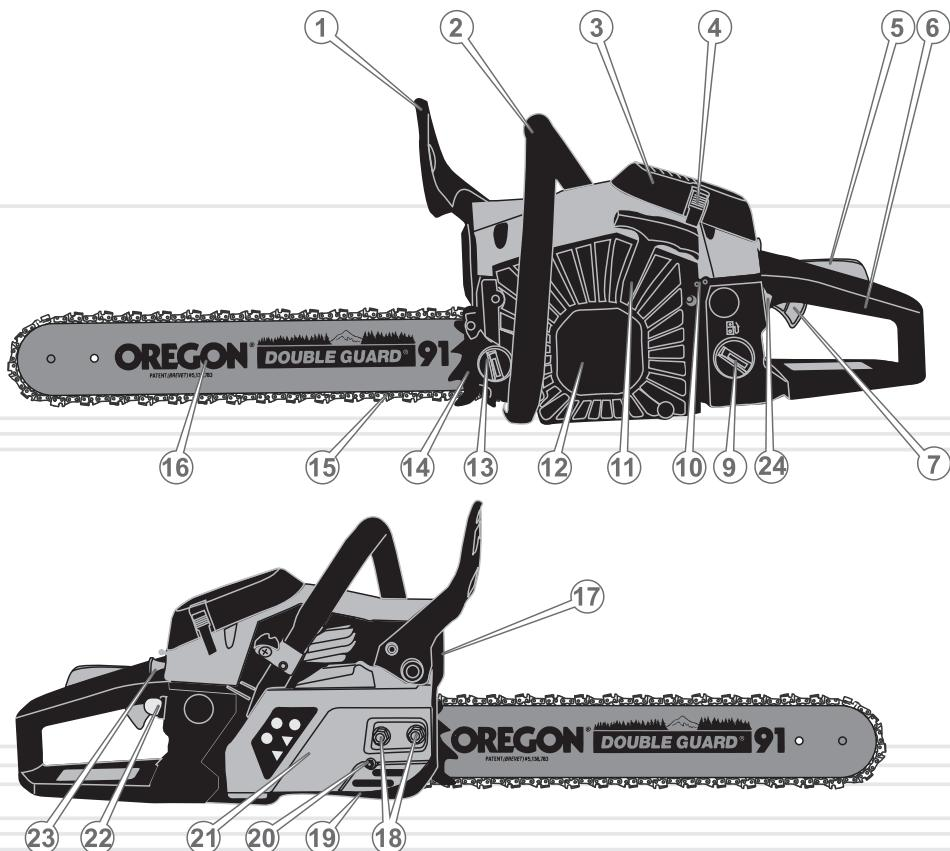
1. Рычаг аварийного тормоза цепи с защитным экраном.
