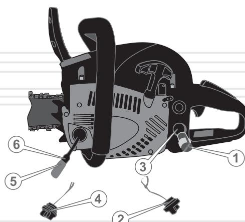
**Обслуговування паливного фільтру**
