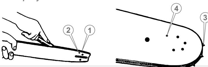
1. Удалите опилки и грязь из желоба шины, масляных отверстий и ведомой звездочки (см. рисунок 22).
