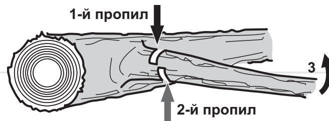
Процесс обрезки сучков и ветвей с поваленного дерева очень напоминает процесс раскряжевки.
