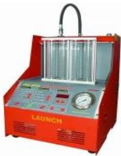
Стенд CNC-402A предназначен для проверки и ультразвуковой очистки всех типов форсунок — электромагнитных и механических. Отличительными особенностями данной установки являются доступная цена, большой комплект переходников, автоматический слив с колб и возможность тестирования до 4-х форсунок одновременно.
