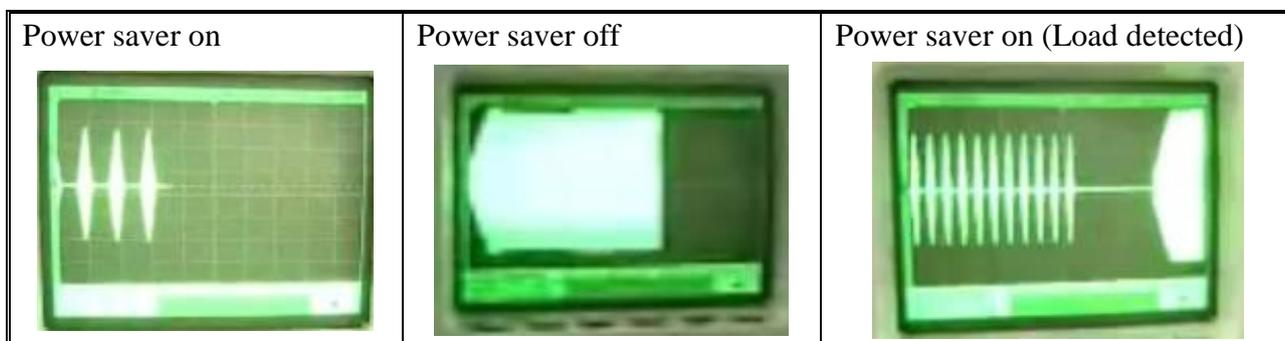
**Примечание: минимальная мощность нагрузки, которая выводит инвертор из «спящего» режима (Power Saver On) – 25 Вт.**
