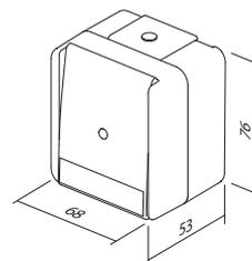
ВЫКЛЮЧАТЕЛЬ КНОПОЧНЫЙ ОДНОПОЗИЦИОННЫЙ IP44 10 A 250V~ \_\_ TI
