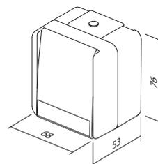
**ДВУХКЛАВИШНЫЙ ОДНОПОЛЮСНЫЙ ВЫКЛЮЧАТЕЛЬ IP44 10 AX 250 В~**
