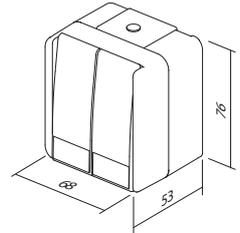
**ВЫКЛЮЧАТЕЛЬ ДВУХПОЗИЦИОННЫЙ IP44 10 AX 250 В ~**
