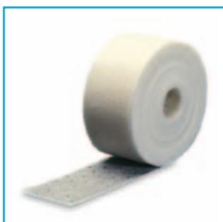
Лента для швов из стекловолокна для армирования внутренних швов и предотвращения появления трещин. Укладывается при помощи шпателя в гипсовую шпаклевку и шпаклевку AQUAPANEL® Q4 Finish.
