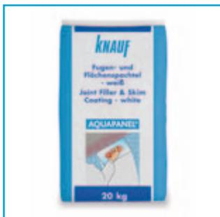
Шпаклевка AQUAPANEL® Joint Filler & Skim Coating - белая – сухая смесь на основе цемента для шпаклевания цементных плит AQUAPANEL® Indoor под облицовку кафельной плиткой. Армирующая сетка AQUAPANEL® Reinforcing Mesh должна быть уложена в слой шпаклевки.
