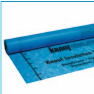
Паронепроницаемый барьер LDS 2 Silk изготовлен из специального полипропиленового материала устойчивого к старению и разрыву. Коэффициент  $S_d \geq 2$  м.
