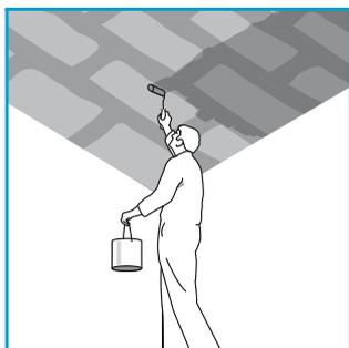
Сразу после высыхания грунтовки можете наносить шпаклевку AQUAPANEL® Q4 Finish на всю поверхность без дополнительного армирования. За один прием не рекомендуется наносить покрытие толщиной не более 2 мм. Сразу после высыхания покрытия отшлифуйте его поверхность наждачной бумагой с зерном 120 или тоньше. Может потребоваться второй слой шпаклевки.
