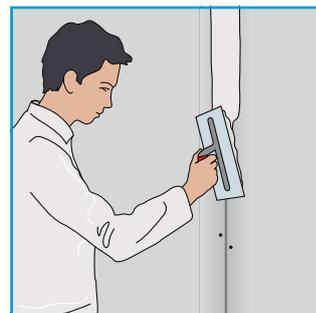
Ведите мастерком поступательно сверху вниз по стыку, прикладывая достаточное усилие, чтобы удалить вовлеченный воздух. Подождите около часа, чтобы шпаклевка затвердела. При необходимости слегка отшлифуйте, чтобы удалить выступы. Затем удалите пыль с поверхности.
