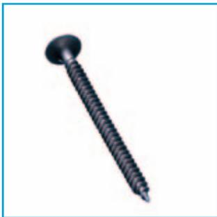
Высококачественные шурупы для крепления гипсокартонных плит обшивки к профилям металлического каркаса (толщина металла до 0,7 мм). Для одного/двух/трех слоев обшивки (в зависимости от длины шурупа). Применяются также при обшивке огнестойких и звукоизоляционных стен.
