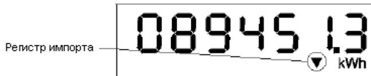
Рисунок 18. Показания суммарного регистра (89451,3 кВтчас, разрешение 6+1)
