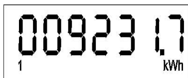
Рисунок 15. Показания тарифных регистров (№1: 98362 кВтчас, разрешение 6+0; №2: 9231,74 кВтчас, разрешение 5+1)
