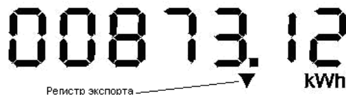
Рисунок 19. Показания суммарного регистра экспорта (873,12 кВтчас, разрешение 5+2)
