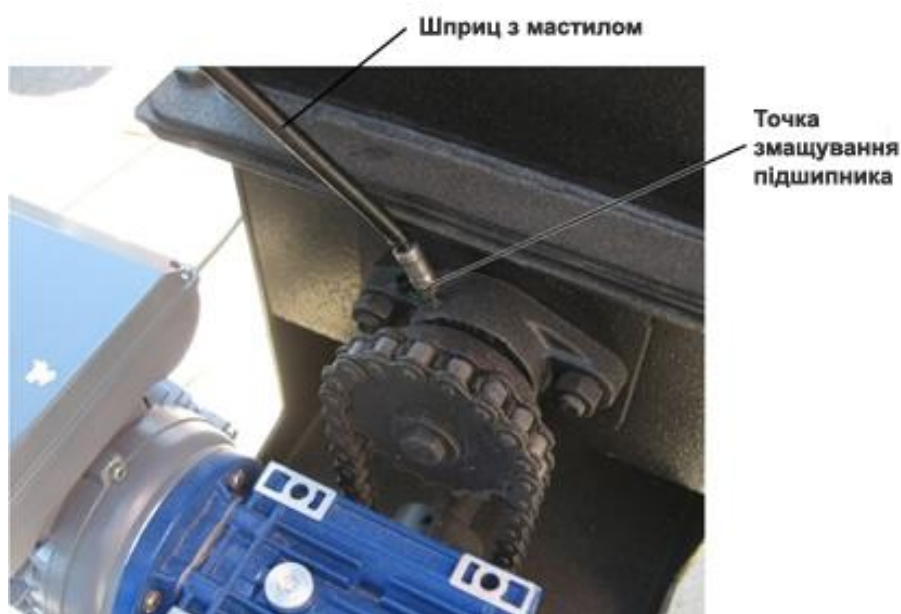
Малюнок 8 - Мастило підшипників шнекової подачі.
