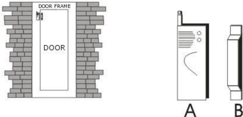
Поверхность двери должна быть ровной сухой и очищенной от загрязнений, для того чтобы надежно прикрепить датчик на двухсторонний скотч идущий в комплекте к датчику.
