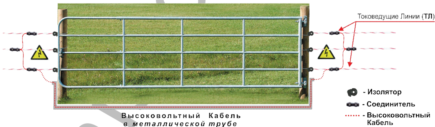
Рис. 12. Устройство ворот в электроизгороди без прерывания гальванической связи
