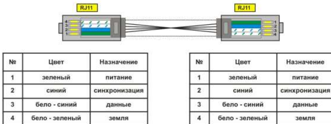
Рисунок 5.2 – Нумерация выводов кабеля КМР-11-1
