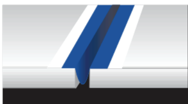
Укладка Маребанд в компенсационный шов
