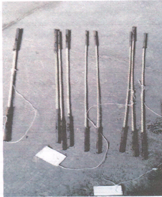
Рис. 1 Зразки композитної арматури до випробування
