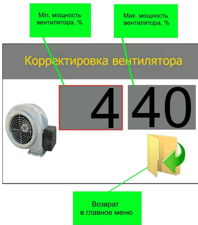
Рисунок 12 – Окно корректировки вентилятора
