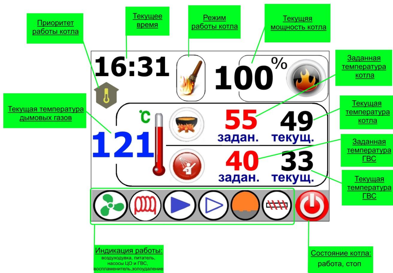
Рисунок 4 – Главный экран регулятора MPT AIR BIO PID
