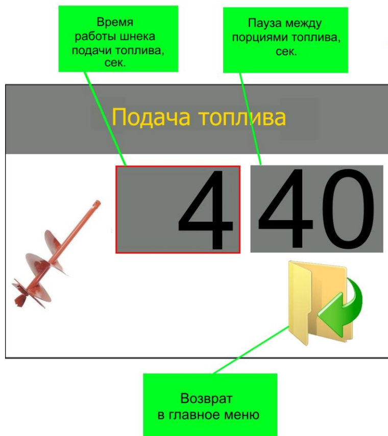
Рисунок 11 – Окно настройки параметров подачи топлива
