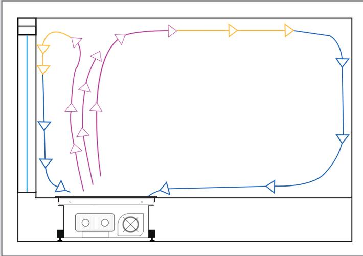
Вентилятор втягивает воздух из помещения, направляет на теплообменник, нагретый воздух нагревает и подсушивает внутреннюю поверхность стекла.
