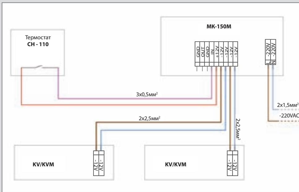
ТИПОВАЯ СХЕМА ВКЛЮЧЕНИЯ МК-150М. РЕГУЛИРОВКА ТЕМПЕРАТУРЫ С ПОМОЩЬЮ ТЕРМОСТАТА СН110. РЕГУЛИРОВКА СКОРОСТИ ВРАЩЕНИЯ ВЕНТИЛЯТОРОВ.
