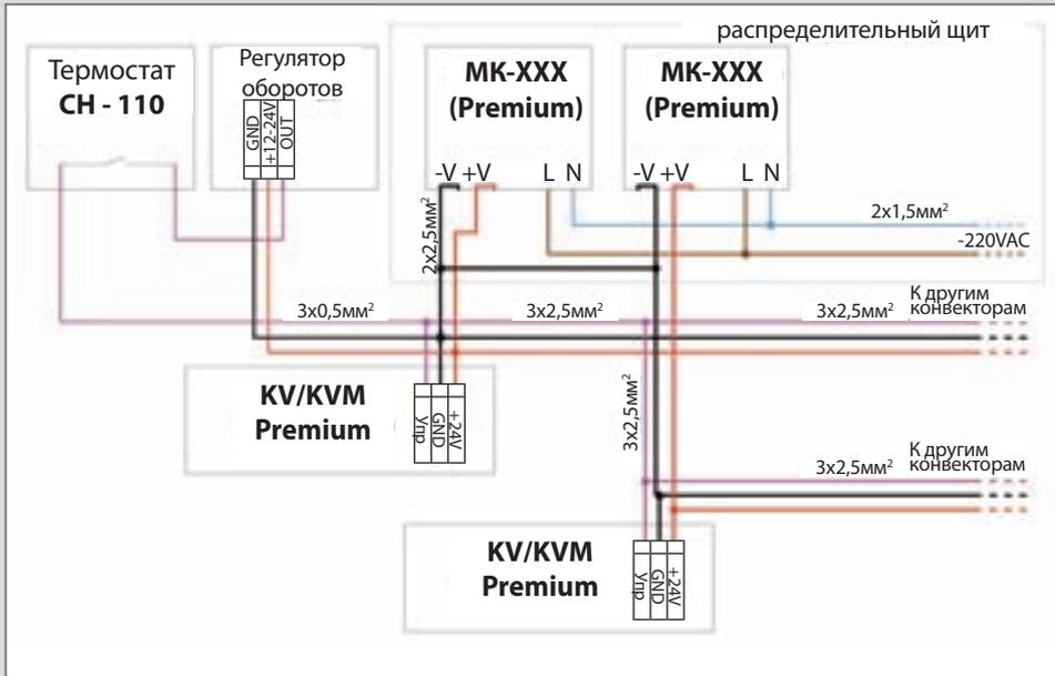
ТИПОВАЯ СХЕМА ВКЛЮЧЕНИЯ МК-PREMIUM. РЕГУЛИРОВКА ТЕМПЕРАТУРЫ С ПОМОЩЬЮ ТЕРМОСТАТА CH110. РЕГУЛИРОВКА СКОРОСТИ ВРАЩЕНИЯ ВЕНТИЛЯТОРОВ. ДВЕ ЗОНЫ РЕГУЛЯТОР+ТЕРМОСТАТ.
