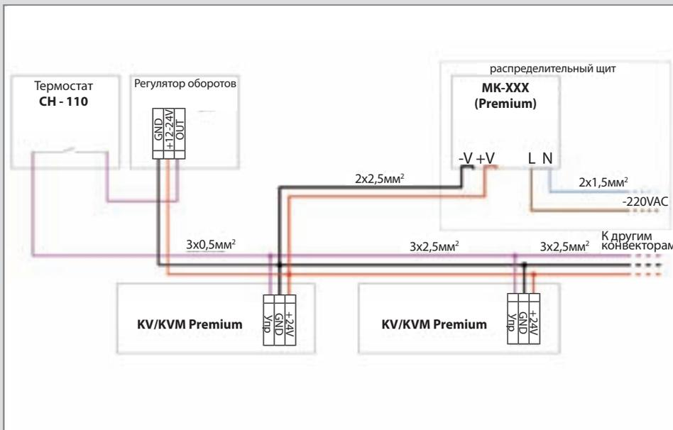
ТИПОВАЯ СХЕМА ВКЛЮЧЕНИЯ МК-PREMIUM. РЕГУЛИРОВКА ТЕМПЕРАТУРЫ С ПОМОЩЬЮ ТЕРМОСТАТА CH110. РЕГУЛИРОВКА СКОРОСТИ ВРАЩЕНИЯ ВЕНТИЛЯТОРОВ. ДВА МОДУЛЯ ПИТАНИЯ В СИСТЕМЕ.
