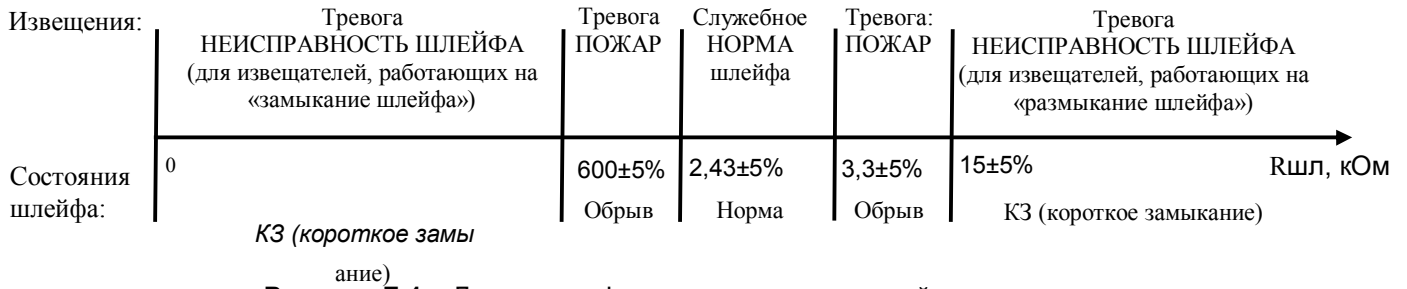
Рисунок Д.1 – Диаграмма формирования извещений при изменении сопротивления пожарного шлейфа
