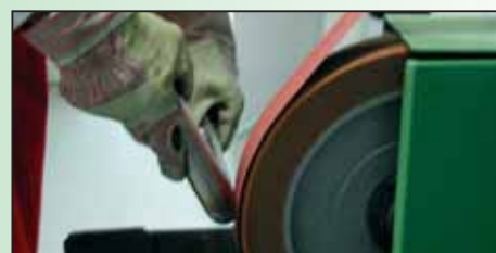
промежуточная обработка нержавеющей стали
