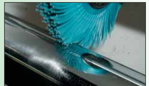
матирование поверхности для гальванизации
