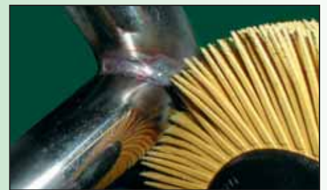
очистка сварных швов
