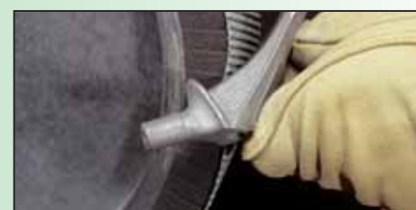
прецизионное шлифование литых деталей
