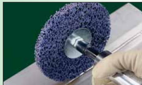
зачистка сварных швов
