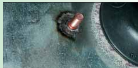
зачистка поверхности, удаление окислов
