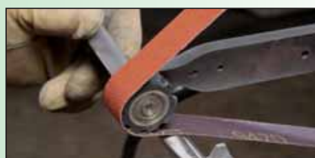
обработка турбинных лопаток
