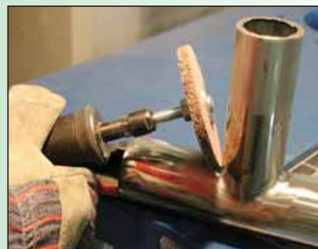
удаление сварного шва в труднодоступных местах
