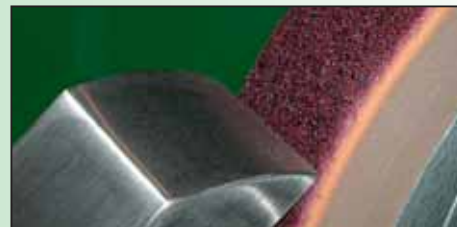
доводка поверхностей из нержавеющей стали
