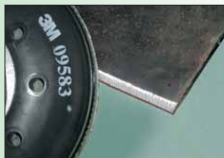
подготовка кромки листа для сварки
