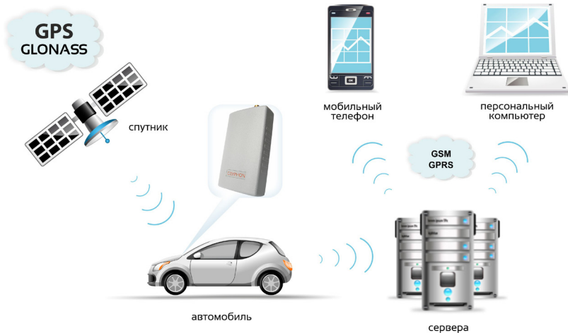
Рисунок 1. Функциональная схема комплекса
