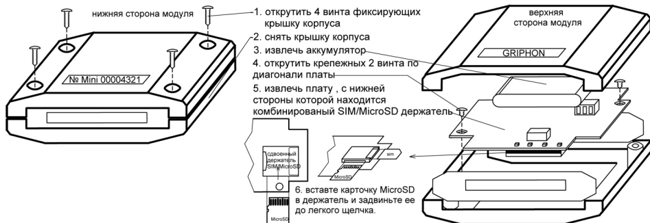
Рисунок 5. Монтаж дополнительной карты памяти в модуль «Gryphon» MINI
