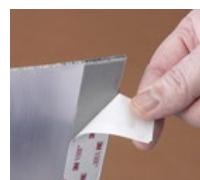
4. Установите приклеиваемую панель в требуемом положении и прижмите ее на профиле в точках где снят лайнер.
