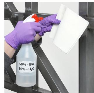
\* при использовании праймера P590 необходимо наносить ленту VHB минимум через 25 мин. и в течении последующего часа. По истечении 90 минут после нанесения поверхность праймера перестает быть активной
