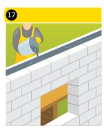
Под плиты перекрытия необходимо устройство монолитного армированного пояса по всему периметру здания, которое также можно выполнить с помощью UDK U-Block<sup>©</sup>.
