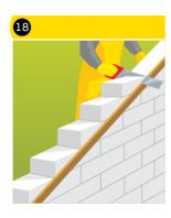
Наклон торцевой кладки можно выполнить прямо на месте, с помощью ручной пилы и терки для шлифования.
