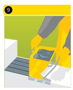
Приготовленный клей UDK ТВМ при помощи специальной зубчатой каретки либо зубчатого ковша, подбираемых по толщине стены, наносится на поверхность блоков толщиной 2-3 мм и равномерно распределяется по поверхности.
