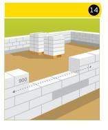
Для кладки верхних рядов рекомендуется обустроить деревянные леса по периметру стены.
