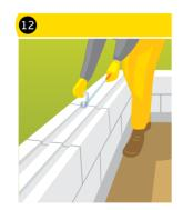
Первый и каждый четвертый ряды кладки рекомендуется армировать по всему периметру. С помощью штробореза прорезаются штробы шириной и глубиной 30-40 мм. В один ряд для блоков толщиной 100-250 мм и в два ряда для блоков 300-400 мм. Отступ от края блоков не менее 60 мм.
