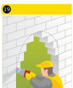
Оконные и дверные проемы сложной формы также можно вырезать ручной пилой.
