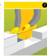
Блоки UDK Gazbeton можно легко пилить прямо на строительной площадке с помощью ручной или механической пилы, применяя направляющий угольник.
