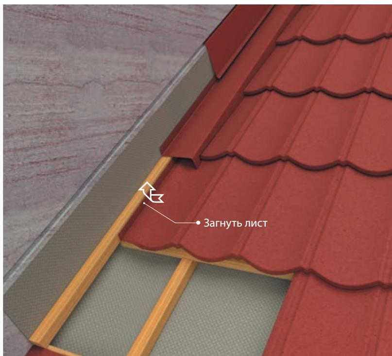
РИС. 29 Боковое примыкание к стене
