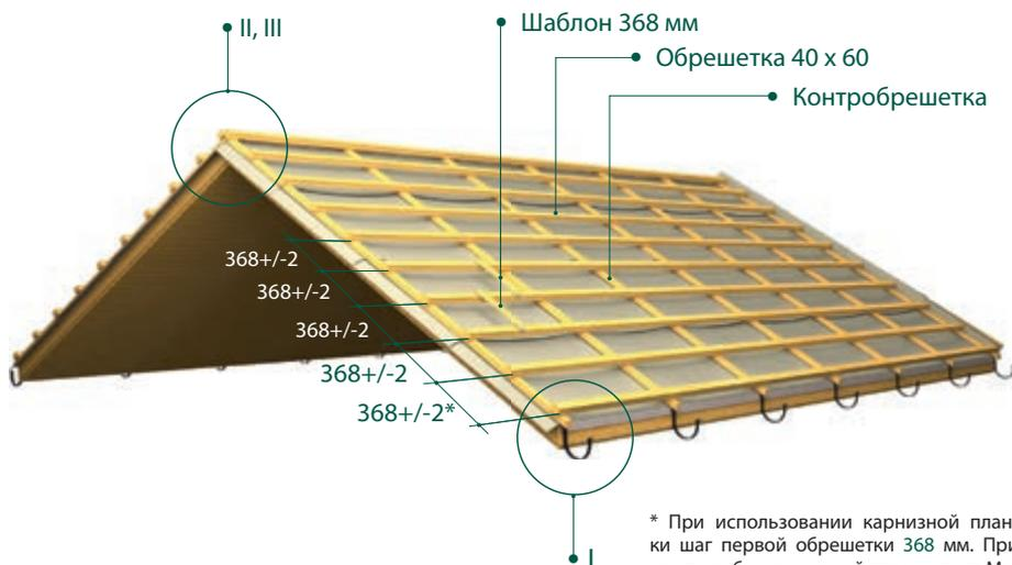
\* При использовании карнизной планки шаг первой обрешетки 368 мм. При монтаже без карнизной планки лист Метротайл необходимо выпустить в желоб, для чего шаг первой обрешетки делается меньшим: 340-370 мм
