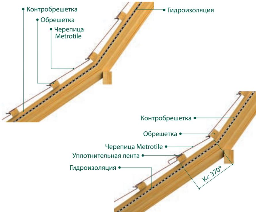
\* Размер зависит от угла наклона скатов и уточняется в процессе монтажа обрешетки.
