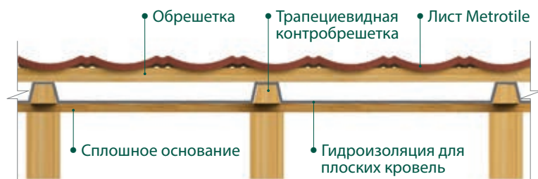
РИС. 38 Кровельный пирог при уклоне кровли менее 10^\circ и менее 15^\circ для формы Viksen .
