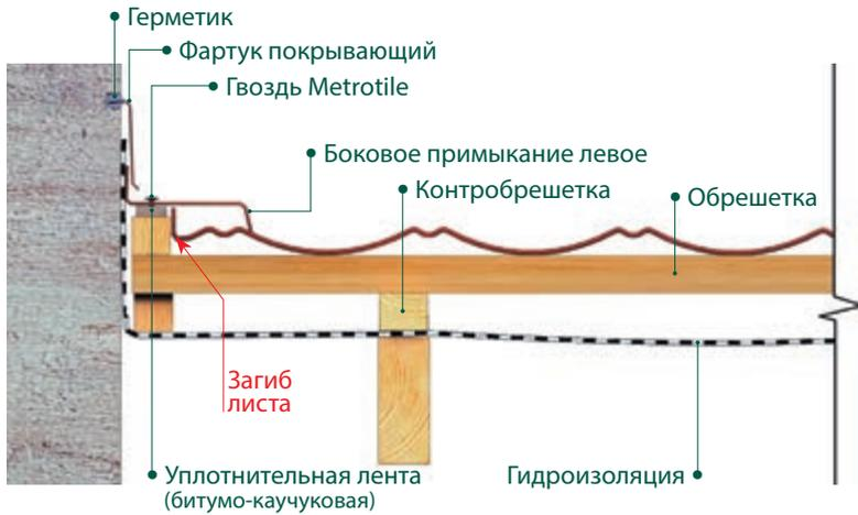
РИС. 30 Разрез бокового примыкания к стене
