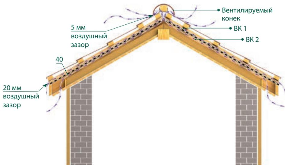
РИС. 1 Вентиляция подкровельного пространства через коньковый элемент
