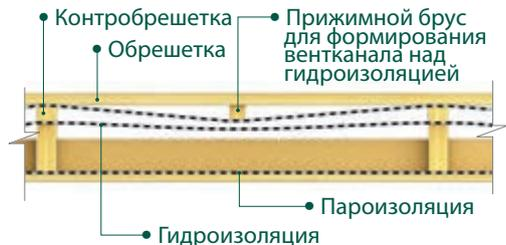
РИС. 5.2. Гидроизоляция конька при использовании гидроизоляционных пленок
