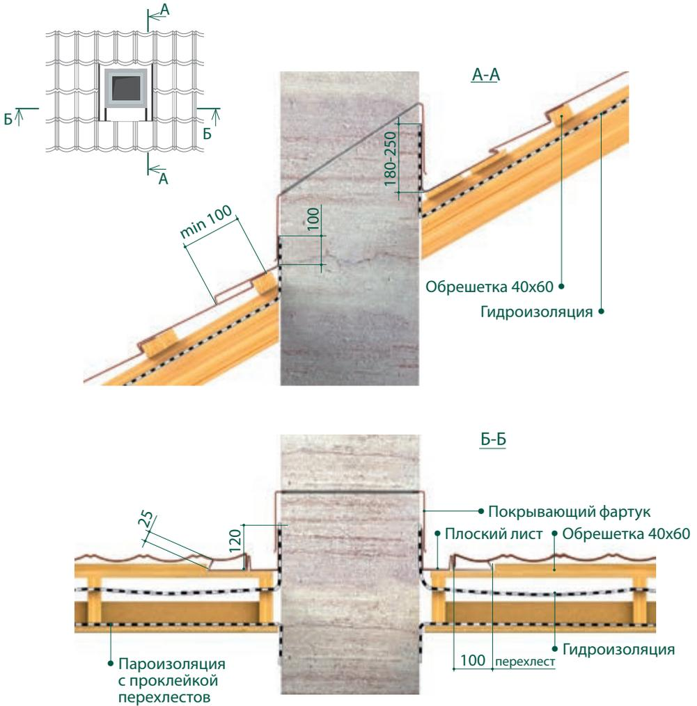
РИС. 33 Монтаж примыкания на утепленной учащенной обрешетке
