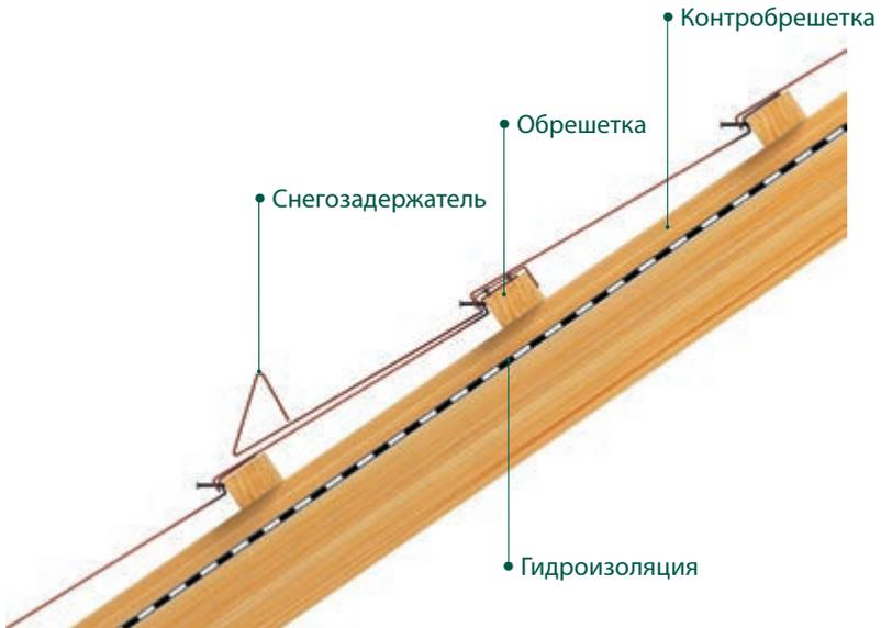
РИС. 37 Монтаж снегозадержателя. Разрез.
