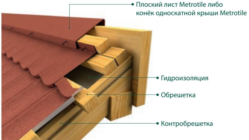
РИС. 22 Формирование конька односкатной кровли/ конёк односкатной крыши Metrotile
