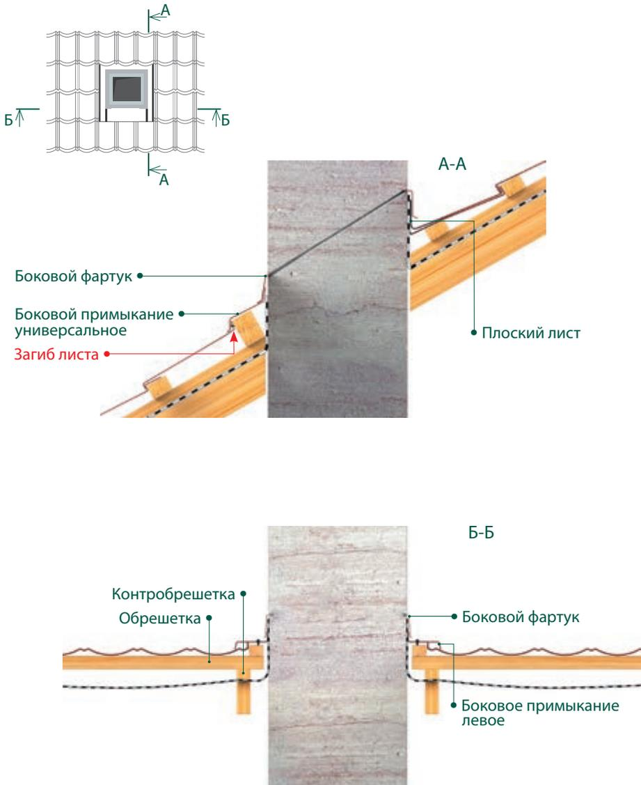
Рис. 33.2 Примыкание к дымоходу планками **MetroTile**<sup>®</sup>. Разрез
