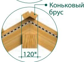
\* В зависимости от угла кровли расстояние между брусками может варьироваться
