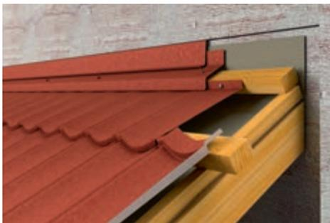
Рис. 31.1 Примыкание к стене
