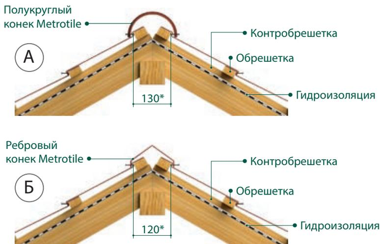
РИС.18. А,Б. Установка коньковых элементов для двухскатной крыши
