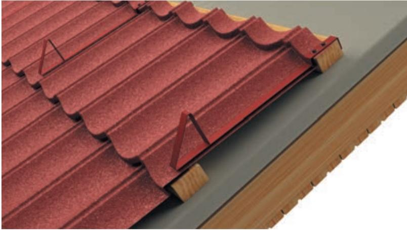
РИС. 36 Установка снегозадержателей
