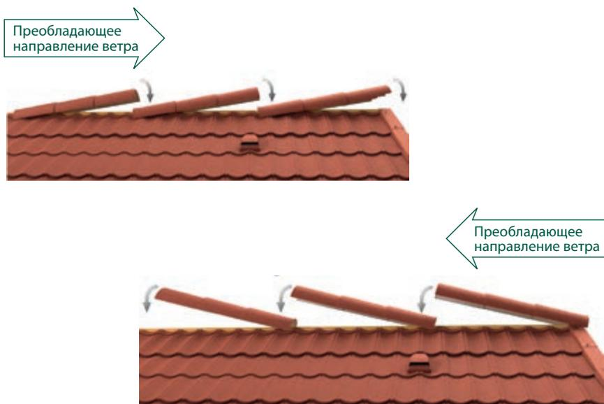
РИС.20 Установка коньков с учетом преобладающего направления ветра
