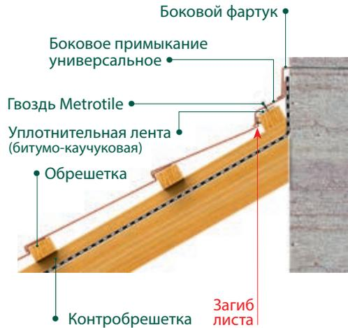
Рис. 31.2 Разрез примыкания к стене
