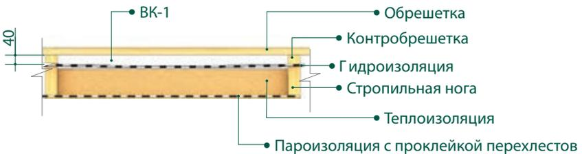
РИС.4.2 Разрез кровельного пирога с использованием супердиффузионной мембраны (провисание мембраны 2 см)
