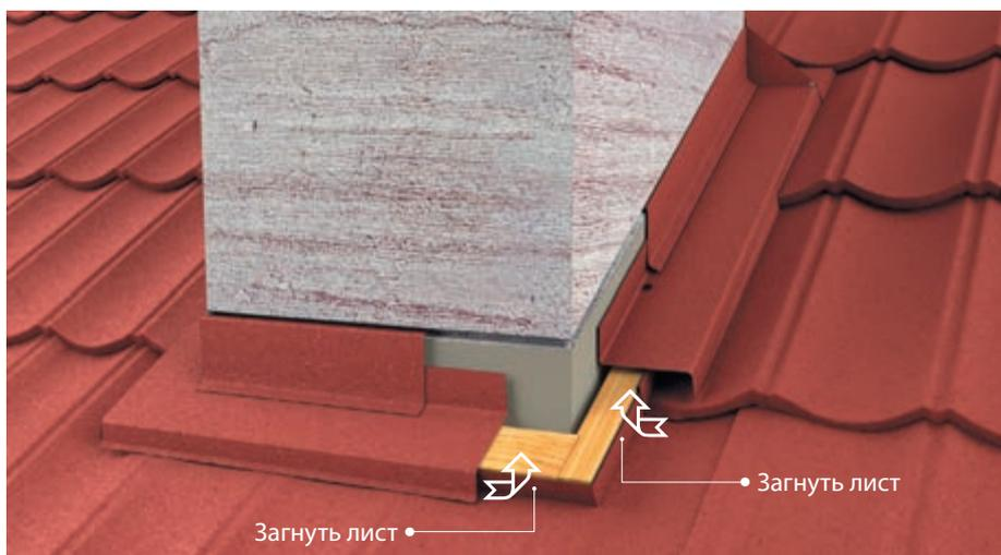
РИС. 33. 1 Примыкание к дымоходу с помощью планок **MetroTile**<sup>®</sup>
