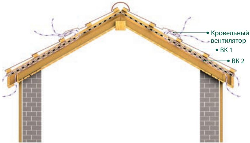
РИС. 2 Вентиляция подкровельного пространства с помощью вентиляторов
