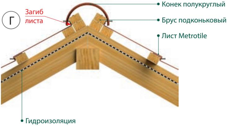
РИС.18. Г. Установка коньковых элементов на два подконьковых бруса
