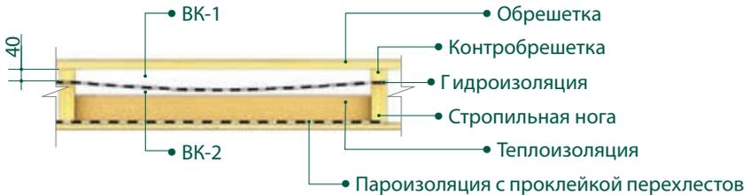
РИС.4.1 Разрез кровельного пирога с использованием конвекционной пленки
