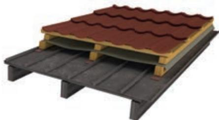
РИС. 40. Монтаж черепицы поверх фальцевого покрытия
