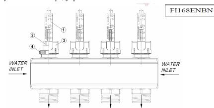
быть сделано путем переворачивания наоборот кольца номер (3), используя его шестиугольную часть для установки требуемого уровня напора.
