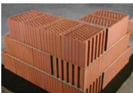
Доборные элементы получают путем прирезки при отсутствии готовых. В каждом углу выводят кладку на три ряда до того, как выполняют кладку стены между ними.
