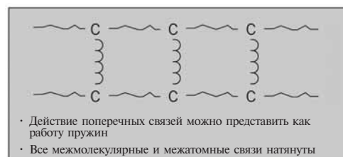
Рис. 2. Структура молекулы сшитого полимера
