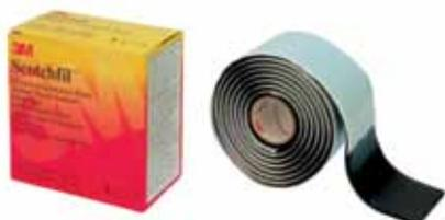
Электроизоляционная мастика толщиной 3,18 мм для изоляции и защиты от влаги, выравнивания поверхностей в местах соединений кабелей, заполнения неровностей и пустот с целью получения ровной основы для последующей намотки изоляционной ленты. Легко подлежит формовке даже при низких температурах. Сохраняет эластичность и устойчивость к атмосферным воздействиям в течение длительного времени.
