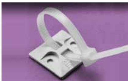
Самоклеющиеся монтажные площадки разработаны для фиксации легких пучков проводов на чистую гладкую обезжиренную поверхность. Для фиксации тяжелых пучков в монтажных площадках предусмотрено отверстие для дополнительного крепления площадки к поверхности при помощи шурупа. Для использования просто удалите защитный слой с клейкой ленты и приклейте площадку в нужном месте. После этого вставьте кабельный хомут в отверстие на площадке для фиксации пучка проводов.
