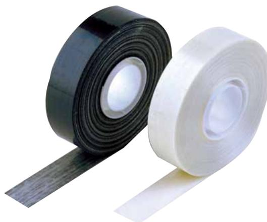
Лента из полиэфира, армированного стекловолокном, для связки кабелей среднего напряжения на открытых электроустановках. Устойчива к динамическим нагрузкам, возникающим в силовых кабелях в режимах коротких замыканий. Обладает очень высокой адгезией и прочностью на разрыв. Модификация черного цвета (bk), устойчива к УФ.
