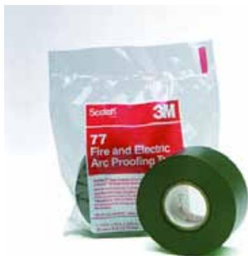
Самозатухающая лента для защиты оболочки кабеля от огня и дугового разряда. Под воздействием высокой температуры лента утолщается, образуя непроводящий защитный слой. Не содержит клеевого слоя. Пластичность ленты Scotch® 77 позволяет производить обмотку кабелей и арматуры неправильной формы.
