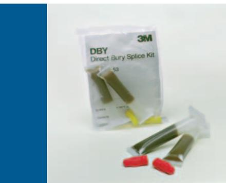
Соединительные /ответвительные муфты серии DBY/DBR предназначены для соединения двух или нескольких медных проводов (одно- или многопроволочных), расположенных непосредственно в грунте для питания дистанционных электрических установок в системах орошения и освещения, напряжением до 30 В.
