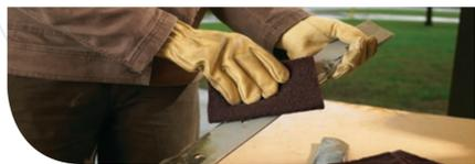
6. Удалить остаточную пыль после абразивной обработки с помощью растворителя. См. п. 7. (дать высохнуть не менее 1 минуты).
