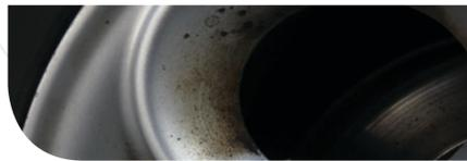
2. Если поверхность покрыта пылью, удалить ее с помощью ветоши из нетканого материала (вискоза).
