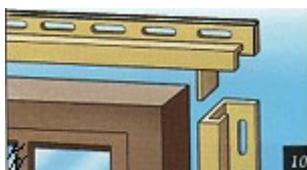
10.Монтаж сайдинга: формирование углов на J-рейке. Отрежьте и установите край j-рейки по обрезу оконного проема (правая деталь на рисунке справа). Другую деталь j-рейки установите над оконным проемом, поверх боковых j-реек. В дне j-рейки, установленный над окном, вырежьте ушко и отогните его вниз.
