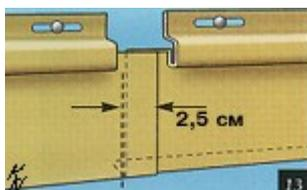
13.Монтаж сайдинга при соединении деталей внахлест. Каждая панель должна перекрывать предыдущую на 2,5-3 см. Последний гвоздь должен располагаться на расстоянии минимум 10 см. от края панели.
