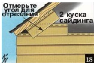
18. Монтаж сайдинга на фронтонах. Измерьте угол наклона крыши, используя отрезок панели. Соедините его с панелью внизу. Другой отрезок панели приложите к коньку крыши. Отмерьте линию угла в том месте, где обе панели перекрывают друг друга. Это будет шаблон для обрезки конца сайдинга, который должен быть установлен с одной стороны фронтона. Повторите действия для другой стороны фронтона.
