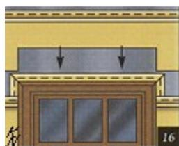
16. Замер панели над окном. Отмерьте и отрежьте панель, повторив предыдущие действия, но от панели отрезайте не верхнюю часть, а нижнюю. Вставьте панель в j-рейку, установленную над окном. Прибейте.
