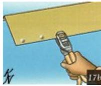
17В. Устройство выступов для крепления верхней панели. Приложите обрезанную панель сайдинга к верхней кромке и проведите линию, где обе детали встречаются. С помощью пассатижей-перфоратора проделайте отверстия в сайдинге на 6 мм ниже верхнего среза с интервалом в 17-20 см, выступы лицевой стороной наружу.
