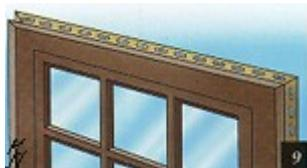
9.Монтаж сайдинга. Монтаж J-рейки вокруг оконных и дверных проемов. J-рейка устанавливается на верх и по бокам оконных и дверных проемов. Прибейте j-рейку вокруг проемов. Не прибивайте слишком плотно! J-рейка также может быть установлена под окном или дверью в качестве завершающего
