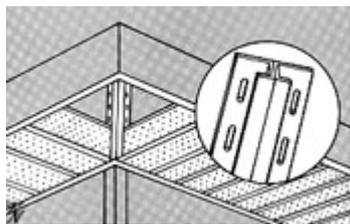
1. Ветровую доску приложите к F-рейке, и к финишной рейке, прикрепленной к свесу крыши, и к финишной рейке, прикрепленной под крышей. Отмерьте ширину ветровой доски, вычтите 5 мм и отрежьте от панели. Замокните нижний край ветровой доски на дне F-рейки. На верхнем крае ветровой доски с помощью пассатижей-перфоратора сделайте выступы на расстоянии 15 см друг от друга. Верхний край ветровой доски заправьте в паз финишной рейки.
