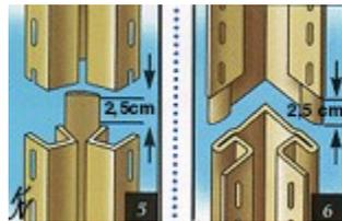
6. Соединения внешнего угла. Монтаж сайдинга по соединению деталей внешнего угла тот же, как и для деталей внутреннего угла.
