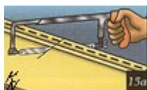
15А. Резка сайдинга. Сделайте вертикальные надрезы на панели с помощью пилы или ножовки по нанесенным отметкам. Затем согните горизонтальную зарубку ножом и согните панель по зарубке несколько раз, пока отмеченная часть не отломится.
