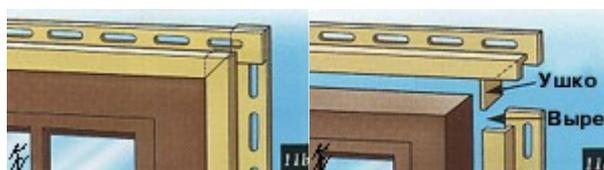
12.Монтаж сайдинга (первой панели). Вставьте нижний край первой панели в стартовую полосу и прибейте верхний край к стене. Установку панелей сайдинга начинайте с тыловой части дома, двигаясь к фасаду. Оставьте расстояние в 6 мм там, где панель попадает на угловую деталь для возможного расширения-сжатия.
