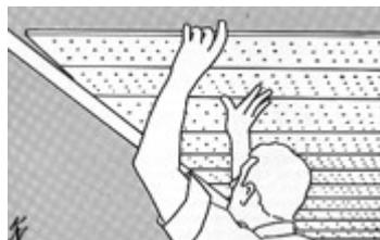
2. Устройство углов поворота. В углах поворота необходимо обрезать панель софита под углом 45 градусов. Используйте две J-рейки, соединенных задними стенками, для создания дополнительной поддержки панелей.
