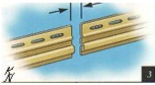
3. Добавление секций стартовой полосы. Когда Вы добавляете секции стартовой полосы, оставляйте между ними расстояние в 6 мм для возможного расширения.
