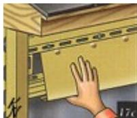
17С. Установка верхней панели. Замкните нижний обрез сайдинга с нижней панелью, а край с выступами - защелкните в паз финишной рейки. Не вбивайте гвозди в лицевую сторону панели!
