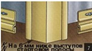
7. Монтаж сайдинга внешнего угла. Установите внешний угол, оставляя сверху расстояние в 6 мм до карниза или J-рейки. Прикрепите деталь, забив гвозди в верхние отверстия по обе стороны детали. Деталь должна висеть на этих двух гвоздях. Располагайте гвозди по центру отверстия для гвоздей, предусмотренных в деталях, на дистанции 20-40 см друг от друга. Это оставит возможность для расширения -сжатия внизу стены. Не прибивайте слишком плотно, это может нарушить монтаж винилового сайдинга!
