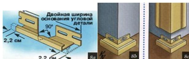
Согните J-рейку по центру (8b) и прибейте к внешнему углу дома. Затем вставьте деталь внешнего угла в образовавшийся канал (8с) и прибейте. Примечание: если ширины j-рейки будет недостаточно для установки в нее угловой детали, то надо отрезать внутреннюю замкнутую часть, увеличивая тем самым ее ширину.
