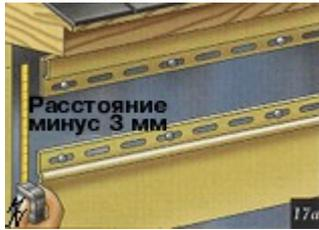
17А. Замер верхней детали. Измерьте расстояние между верхом внутреннего паза верхней кромки и выступом панели сайдинга внизу вычтите 3 мм. Отрежьте верх панели по этой мерке.
