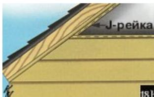
18В. Замкните панель сайдинга с нижней панелью и вставьте в паз J-рейки. Примечание: оставляйте зазор в 6 мм между сайдингом и j-рейкой для возможного расширения.
